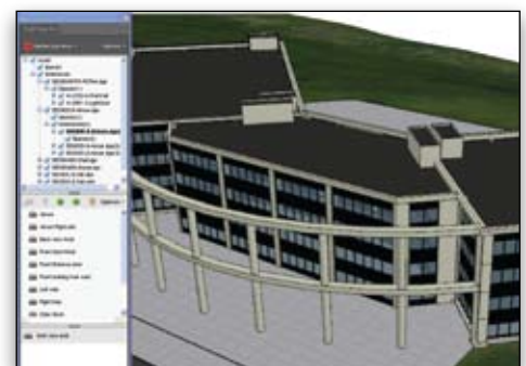
Verkürzung von Bauabstimmungsprozessen durch den Export von 2D-Plänen und virtuell begehbaren 3D-Modellen im Standardformat PDF, samt Ebenstrukturen (über MicroStation, MicroStation PowerDraft)
